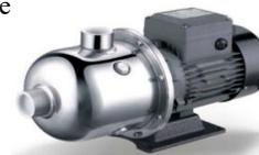
Материал проточной части нержавеющая сталь AISI 304, максимальная температура перекачиваемой жидкости до +85°C. Максимальная высота всасывания - 8 метров.
